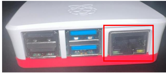
Figure 11: Port Ethernet vu de l'extérieur (Source: Auteurs)
