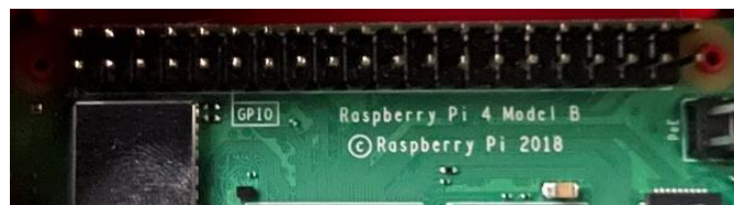
Figure 6: GPIO dans la carte-mère (Source: Auteurs)
