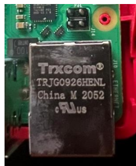
Figure 10: Port Ethernet dans la carte-mère (Source: Auteurs)
